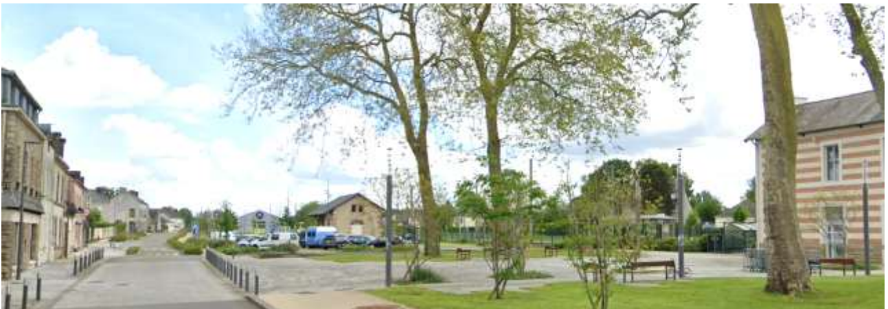
Exemple d'aménagement aux abords de gare (matérialisation des itinéraires modes actifs par changement de matériaux, abri et box vélos, bancs, espace de stationnement végétalisé) (Malansac, 56)
